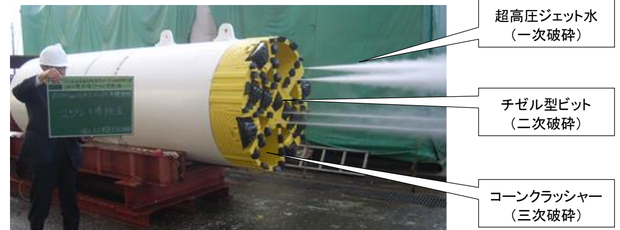
写真-3 超高圧ジェット水とチゼル型ビットを装備した掘進機
